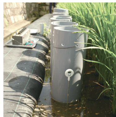
水田に設置された「泥の電池」
